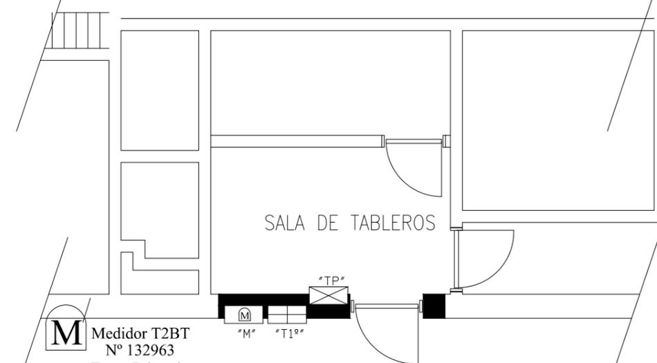
M Medidor T2BT N° 132963 Toma Primaria Medidor a Desafectar
